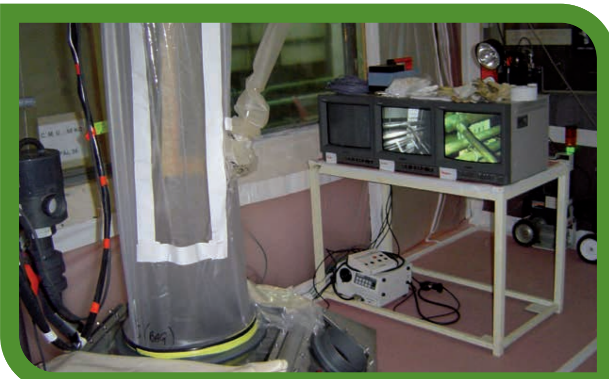
Dispositif d'inspection par caméra de l'intérieur d'une cuve.
