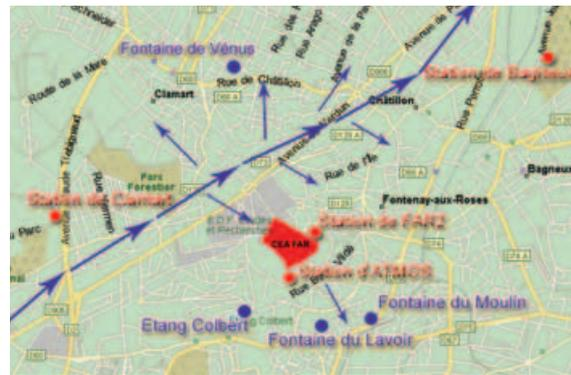
Figure n°2 : implantation des stations de contrôle de l'environnement (les flèches bleues indiquent la direction d'écoulement de la nappe phréatique).
