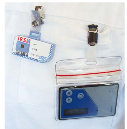
Dosimètre passif (à gauche), dosimètre opérationnel (à droite).
