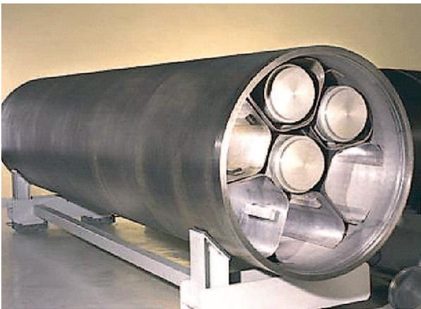
Fig. 145. Démonstrateur « échelle 1 » du conteneur d'entreposage.
