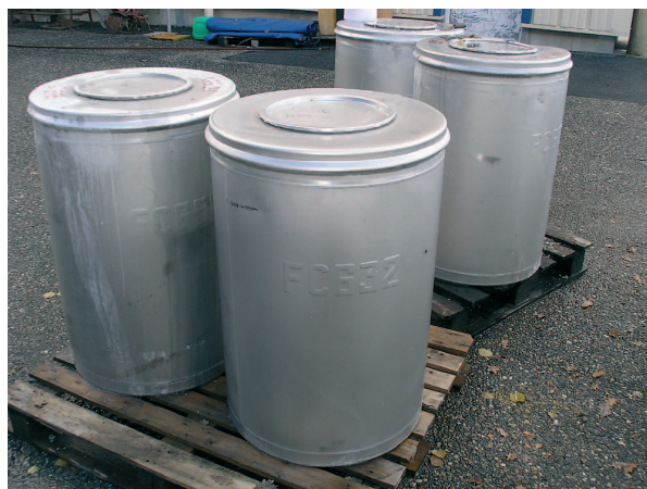
Fig. 74. Colis bitume extraits du conteneur béton après essai de chute en coin.
