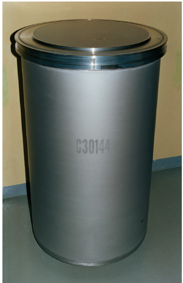
Fig. 97. Fût de tronçons de gaine et embouts cimentés.
