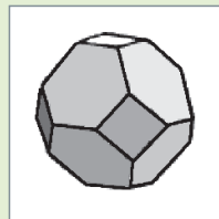
Fig. 125. a. Octaèdre tronqué, figure de base des zéolites, analogue à la cage \beta de la sodalite (chaque trait représente une liaison Si-O-Si ou Si-O-Al).
