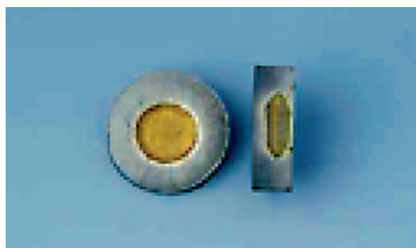
Fig. 109. Photo de pastilles tronçonnées ( \text{Pb}_{10}(\text{VO}_4)_{4,8}(\text{PO}_4)_{1,2}\text{I}_2 , en jaune, et \text{Pb}_3(\text{VO}_4)_{1,6}(\text{PO}_4)_{0,4} , en gris) pour le confinement de l'iode.
