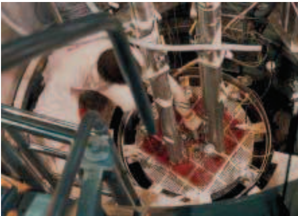
Fig. 1. Maquette critique ÉOLE vue de dessus, en cours de préparation pour la réalisation d'essais de qualification d'un cœur de réacteur à eau bouillante.
