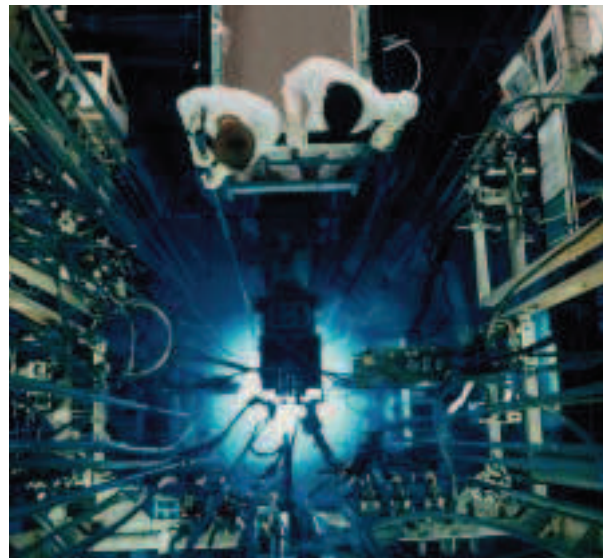
Fig. 29. Vue de dessus du réacteur piscine OSIRIS, destiné à l'irradiation des matériaux et des combustibles.
