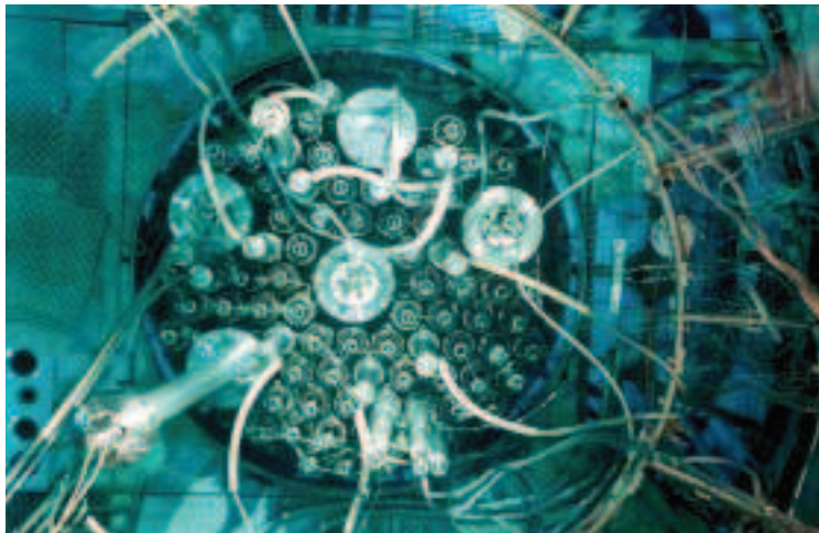
Fig. 2. Un exemple de réacteur d'irradiation technologique de type « à caisson fermé » : le réacteur BR2 du SCK/CEN (Belgique).
