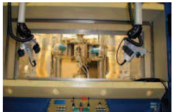
Fig. 79. Une machine de traction en cellule chaude, au LECI.
