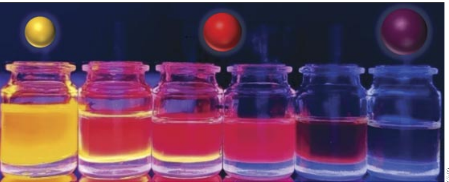
▲ Quantum dots de phosphure d'indium (InP) de taille croissante d'environ 4 à 11 nm (de gauche à droite) sous lumière UV.
