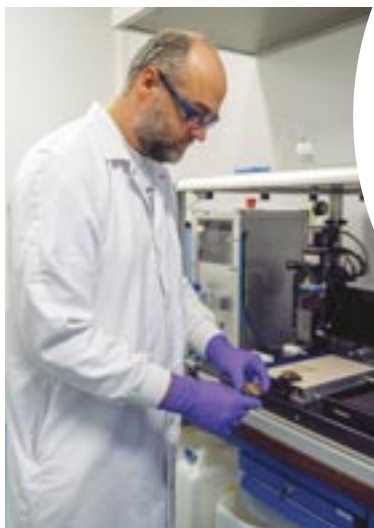
◀ ▲ Robot spotteur, un système de dépôt pour la fabrication de puces multiplexées.
