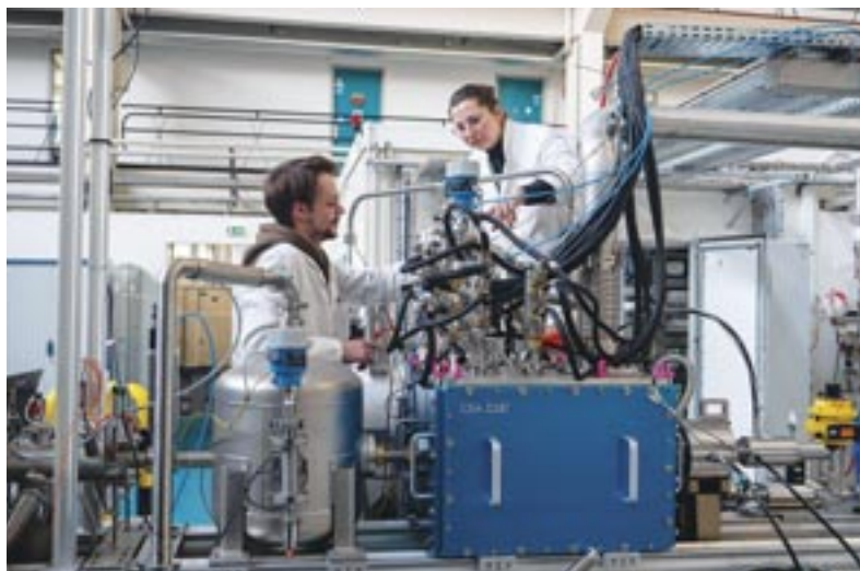
▲ Le cryostat, pièce centrale du banc d'injection de glaçons développé par le DSBT pour le projet ITER-DMS.
