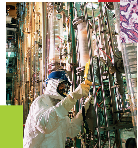
Colonnes pulsées du procédé Purex. © P. Stroppa/CEA
