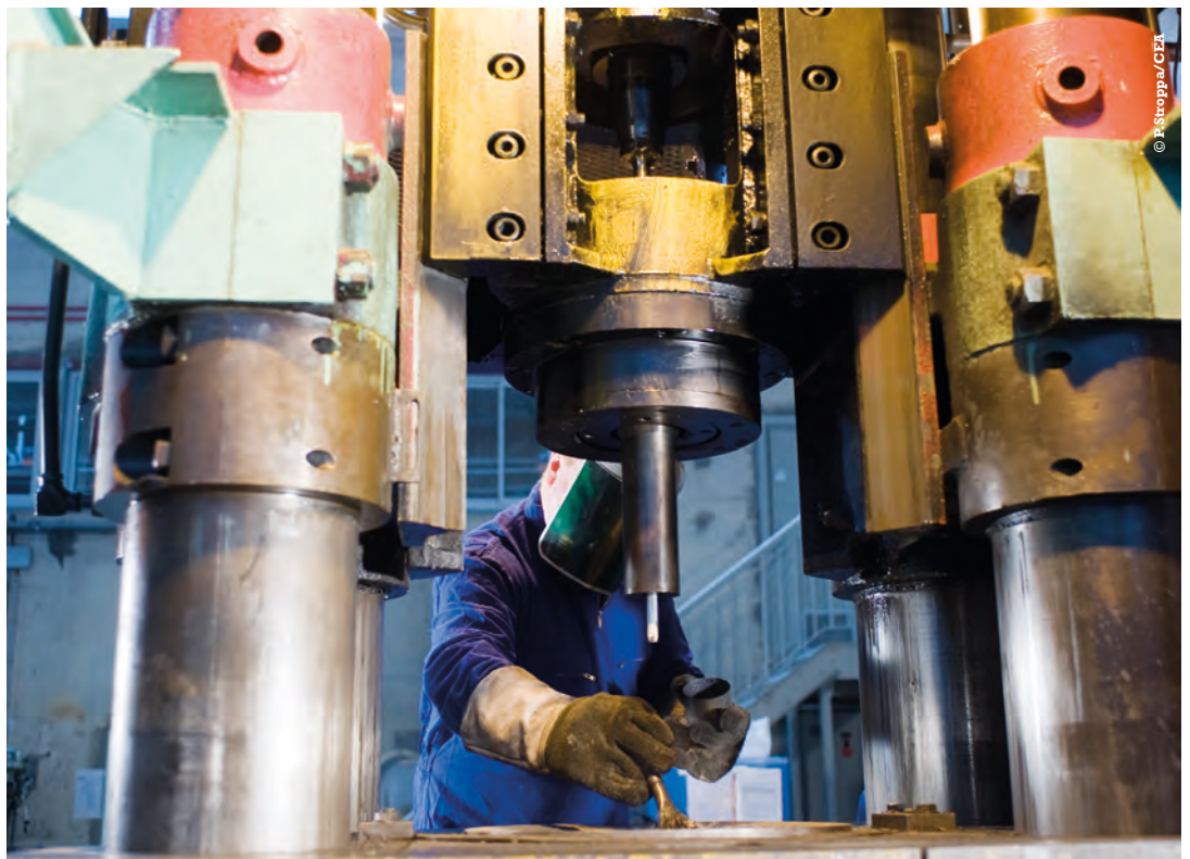
Filage à chaud de gaines en acier ODS sur la chaîne de fabrication du CEA-DEN à Saclay.
