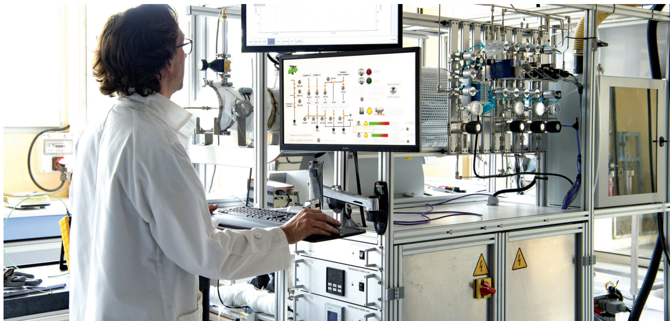
R&D SUR L'EHT. Installation de dépôt de revêtement anticorrosion par voie chimique en phase vapeur.
